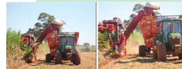
Fotos 7 e 8 - Trator descentralizado pisando na soqueira (esp. 1,40m)
