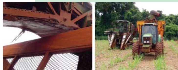
Fotos 3 e 4 - Injúrias no elevador da colhedora, causada pelo transbordo, devido ao espaçamento utilizado de 1,40m e pisoteio na soqueira para evitar estragos no elevador.
