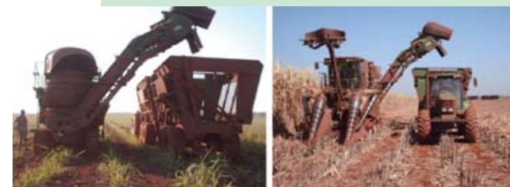
Fotos 5 e 6 - Espaçamento de 1,50 metros, ideal para a colheita mecanizada (simulação de colheita em touceiras altas cortadas manualmente).
